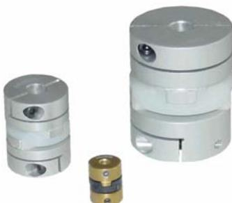
Pružné spojky typu Oldham se skládají ze dvou hlavic a plastového středu. Spojky volně kompenzují případné nesouososti při minimálním zatížení ložisek motoru. Tlumí hluk, vibrace a rezonance zvláště v provedení s bílým (nylonovým) středem.
